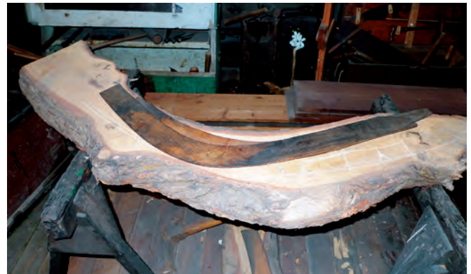
Nutzung der natürlichen Krümmung eines Baumes. Mit einer Schablone wird die Krümmung angezeichnet und danach ausgesägt.
