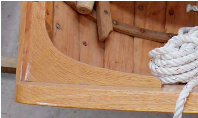
Stark beanspruchte Bauteile wie bei dieser Bootsverstärkung, werden aus gebogenem Holz gefertigt.
