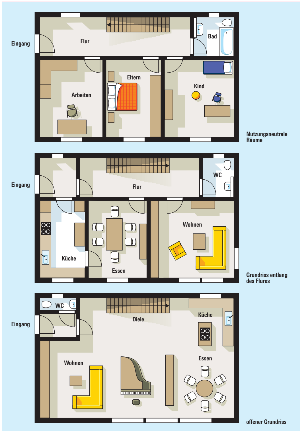
Ein Grundriss mit an einem Flur aufgereihten Räumen (Mitte) und ein komplett offener Grundriss (unten).
