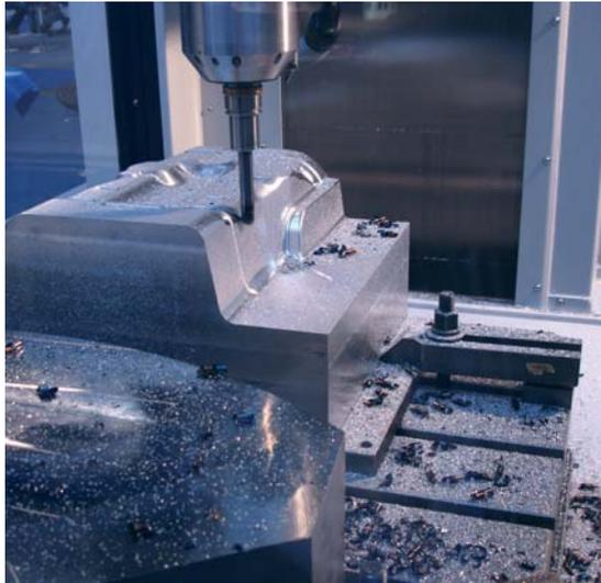
Bild: Materialabtrag beim Fräsen.
