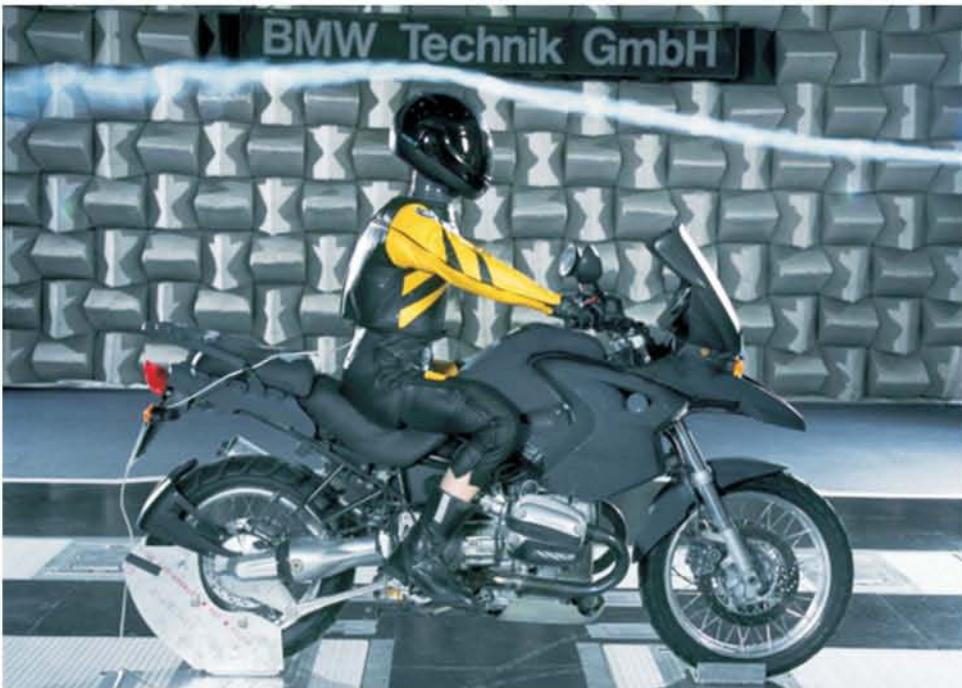
**Bild 2.2** Luftwiderstandsmessung im Windkanal
