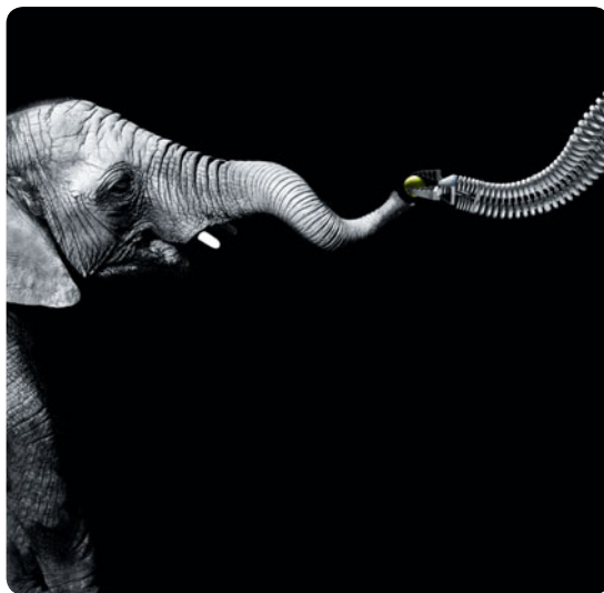
Bild: Funktionsweise und Struktur des Handling Assistenten sind durch einen Elefantenrüssel inspiriert. Als Basistechnologie dienen Mechatronik und Pneumatik. Generative Fertigungsverfahren ermöglichen die Herstellung./ Foto: Festo
