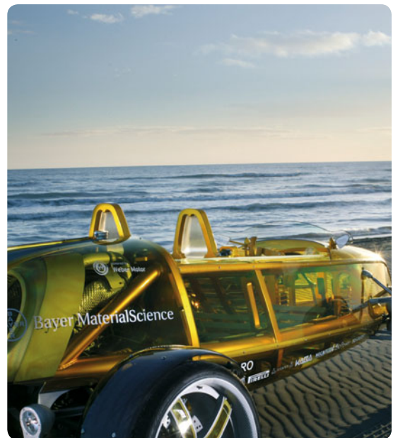
Bild: Fahrzeug mit transparenter Karosserie (Quelle: Bayer MaterialScience, Rinspeed AG, Frank M. Rinderknecht)
