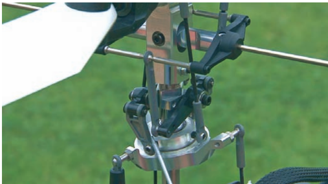
Bild 5.3: Besonders anfällig ist der Bereich direkt an der Taumelscheibe. Von potenziellen Verkantungen kann aber auch das vom Servo zur Taumelscheibe führende Antriebsgestänge betroffen sein.
