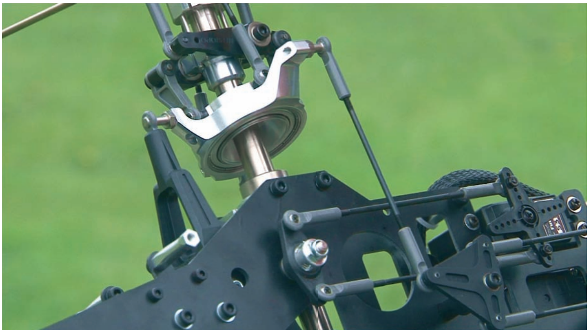
Bild 5.7: Bei korrekter Einstellung lässt sich die Taumelscheibe ausreichend weit auslenken, ohne dass Gefahr besteht, dass sich einzelne Teile verkanten.
