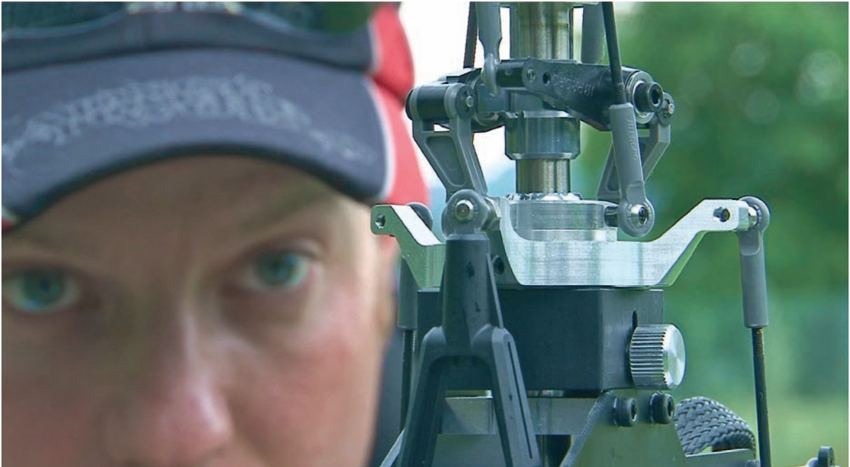
Bild 4.14: Bis die Taumelscheibe genau ausgerichtet ist, sind zumeist mehrere Versuche nötig. Sie erfordern, dass das Gestänge immer wieder für Kontrollen eingebaut wird.
