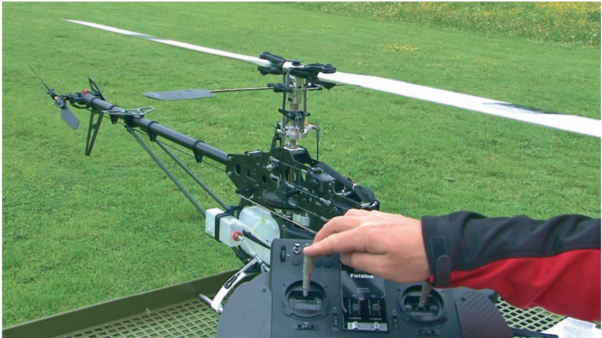
Bild 6.4: Zuletzt überzeugt man sich anhand einer Kontrolle über den kontinuierlichen Verlauf der programmierten Kurve.
