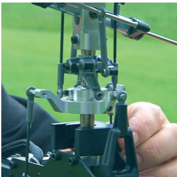
Bild 4.7: Nachdem die Taumelscheibe mit der Fernsteuerung auf ihre obere Endauslenkung gebracht wurde, ist sie auf die Rotorwelle zu schieben.
