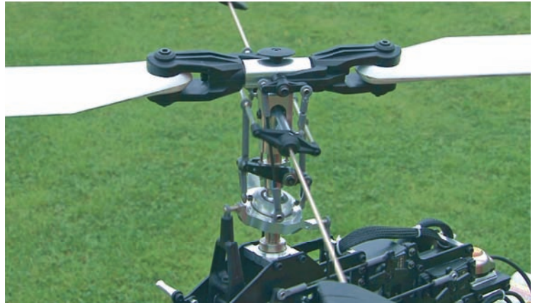
Bild 5.1: Die Taumelscheibe ist im weiten Rahmen frei in alle Richtungen beweglich. Ihr Bewegungsspielraum ist sogar um einiges größer, als es für den Flugbetrieb erforderlich ist.
