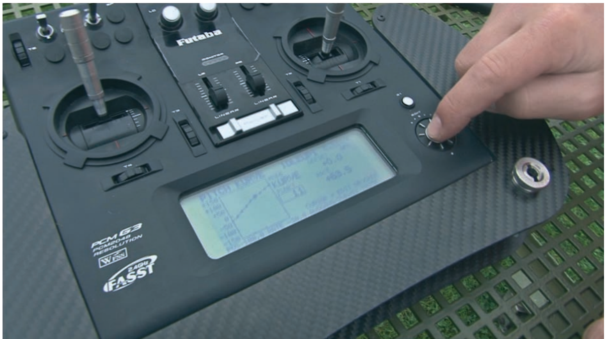
Bild 6.3: Ziel sollte sein, eine lineare oder fließend verlaufende Kurve zu programmieren. Nur so führt die Taumelscheibe, während der Steuerknüppel in eine Richtung bewegt wird, eine harmonische, ruckelfreie Bewegung aus. So lässt sich der RC-Helikopter auch angenehmer steuern.
