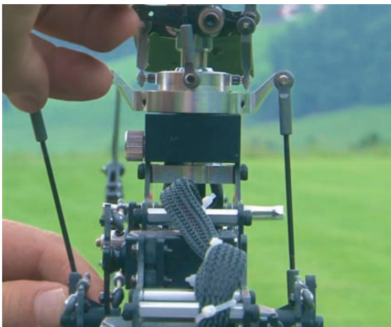
Bild 4.11: Seine Länge ist durch Verdrehen des Gelenkkopfs anzupassen.
