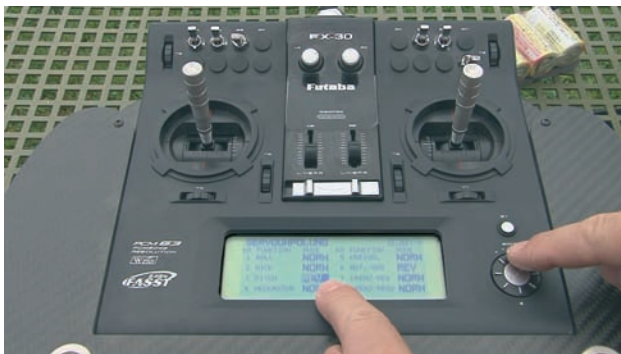
Bild 4.3: ... auf Reverse umgepolt. Damit wurde seine Richtungsumkehr programmiert.
