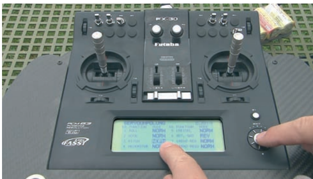
Bild 4.2: Die meisten Fernsteuerungen bieten, entweder als Schalter oder in einer Menüsteuerung eingebettet, für jeden Steuerkanal eine sogenannte Reverse -Funktion, mit der ein falsch angeschlossener Servo auf elektronischem Weg umgepolt werden kann. Hier ist der Pitch -Servo von Normal ...
