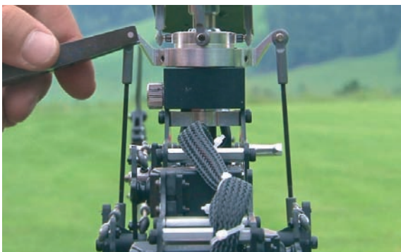
Bild 4.10: Das Gestänge ist mit einer Kugelpkopfzange vorsichtig von der Taumelscheibe abzunehmen.
