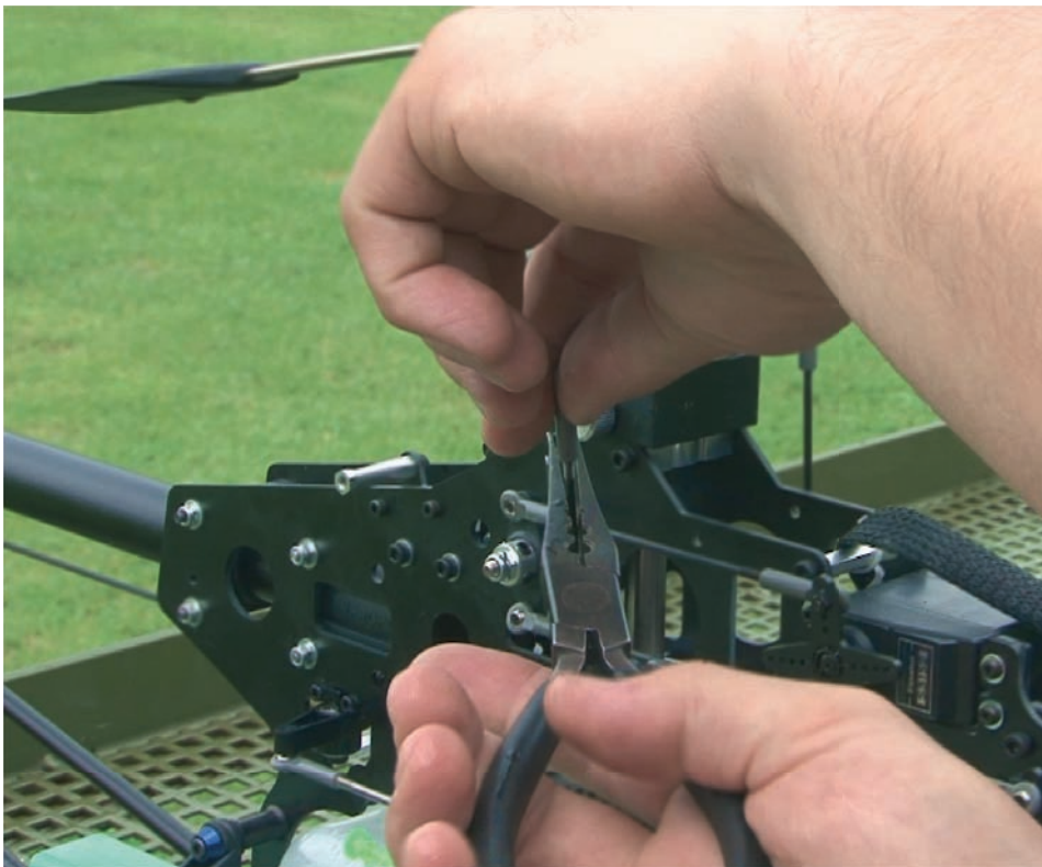
Bild 4.13: Zuletzt ist das auf Maß gebrachte Gestänge wieder mit der Kugelkopfzange auf die Taumelscheibe zu stecken.
