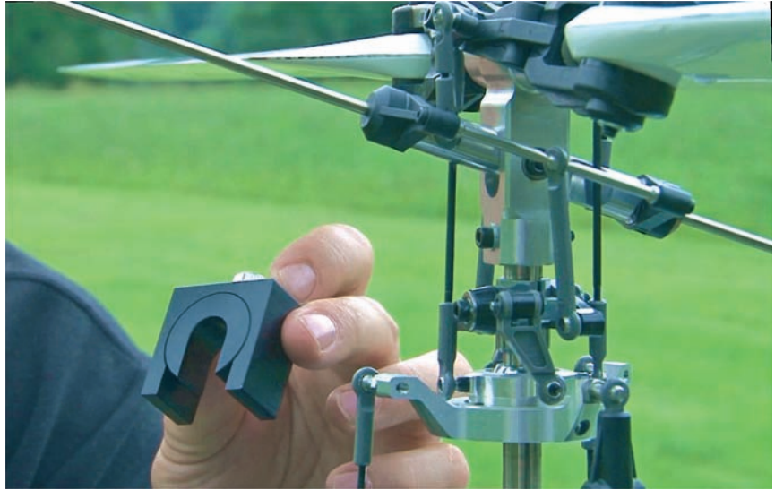
Bild 4.5: Zum Einrichten der Taumelscheibe wird eine sogenannte Taumelscheibenlehre benötigt.
