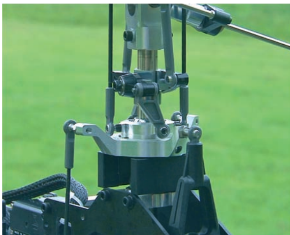
Bild 4.8: Anschließend ist die Taumelscheibe nach unten zu bewegen, bis sie an der Lehre ansteht.
