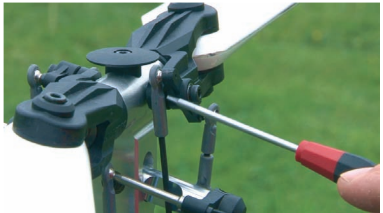
Bild 5.2: Die Taumelscheibe kann das an ihr befestigte, zu den Rotorblättern und der Paddelstange führende Gestänge so weit bewegen, dass sich dieses mit Gelenken oder Wellen sogar verkanten kann.
