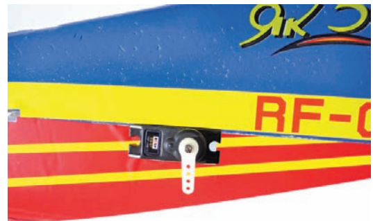
Bild 5.2 – Die Servos für das Höhen- und Seitenruder sind am hinteren Ende des Rumpfs eingebaut.
