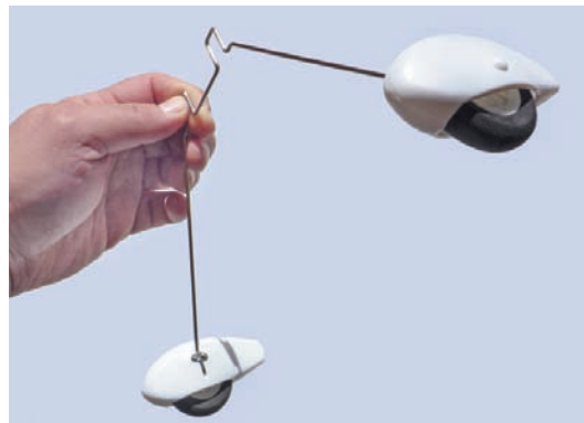
Bild 5.16 – Das Fahrwerk sollte nur eingebaut werden, wenn das Modell von einer Hartpiste gestartet wird und dort auch landet.
