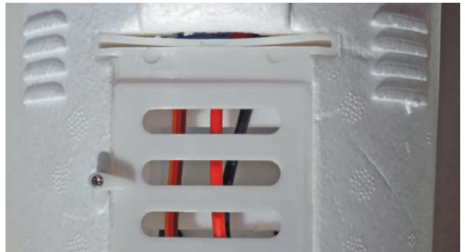
Bild 5.15 – An der Rumpfunterseite befindet sich ein Schlitz, in den das Fahrwerk zu stecken ist.
