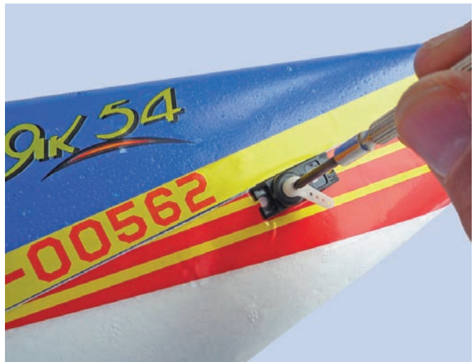
Bild 5.4 – Befindet sich ein Servo nicht in 90°-Neutralstellung, ist der Servohebel neu auf die Welle aufzusetzen.
