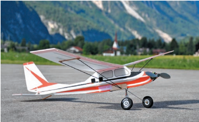
Bild 4.3 – Slow-Flyer sind aus einfachen Schaumstoffteilen zusammengebaut und primär für den Einsatz in Hallen vorgesehen.
