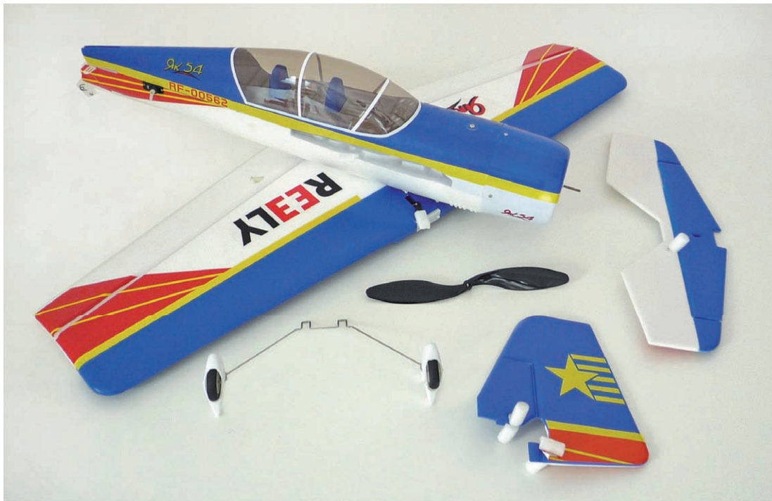
Bild 5.1 – Ready-to-Fly-Flieger kommen in vormontierten Einzelteilen und müssen erst zusammengesetzt werden.
