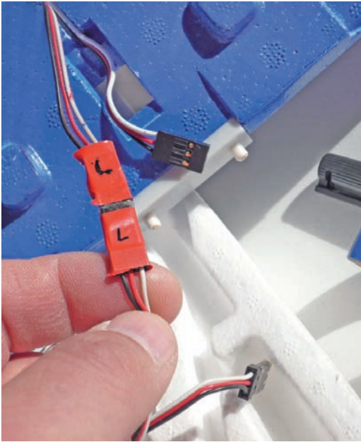
Bild 5.11 – Um die Kabel jederzeit richtig zu verbinden, sind die Stecker farblich zu kennzeichnen und zu beschriften.
