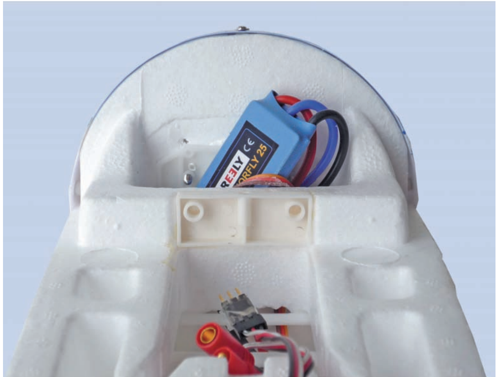
Bild 5.9 – Die Tragflächen sind im entsprechenden Gegenstück unter der Kanzel einzuhängen.
