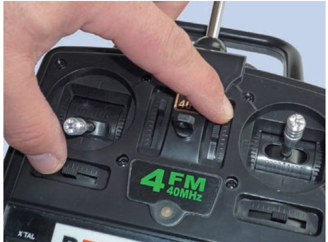
Bild 5.3 – Die Trimmhebel für das Seiten- (links unten) und Höhenruder (rechts mittig) sind in Neutralstellung zu bringen.
