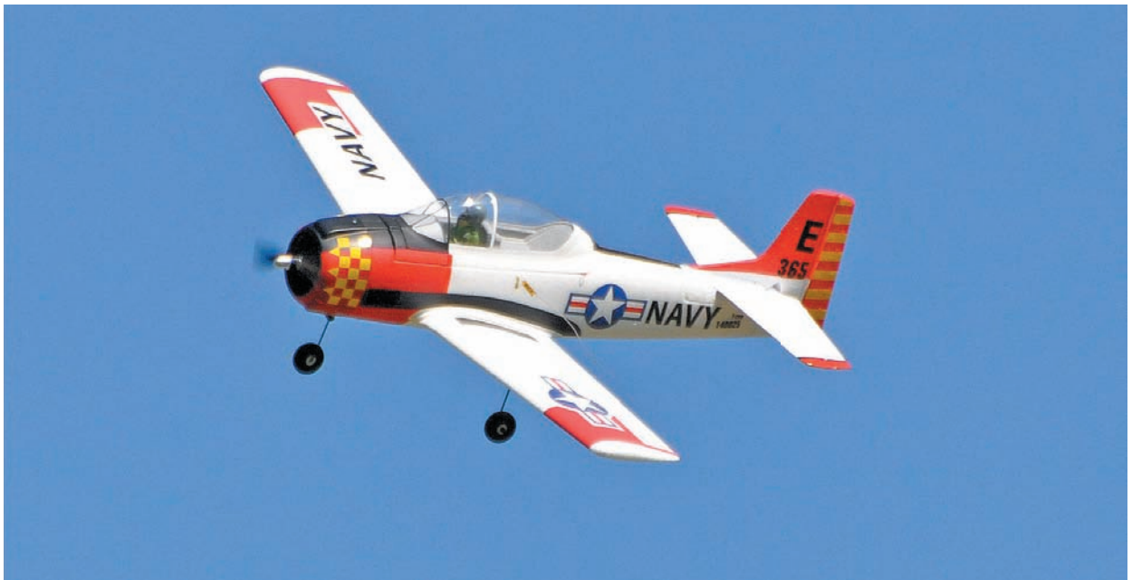
Bild 4.2 – Die T28 Trojan mit einer Spannweite von 1.100 mm und einem Gewicht von 900 g ist ein typisches Fertigmodell aus Formschaum.
