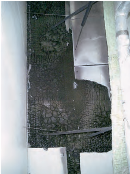
Abb. 8.10: Schaumglas bleibt nach dem Brand in der Substanz erhalten, die Oberfläche ist nur teilweise angeschmolzen.
