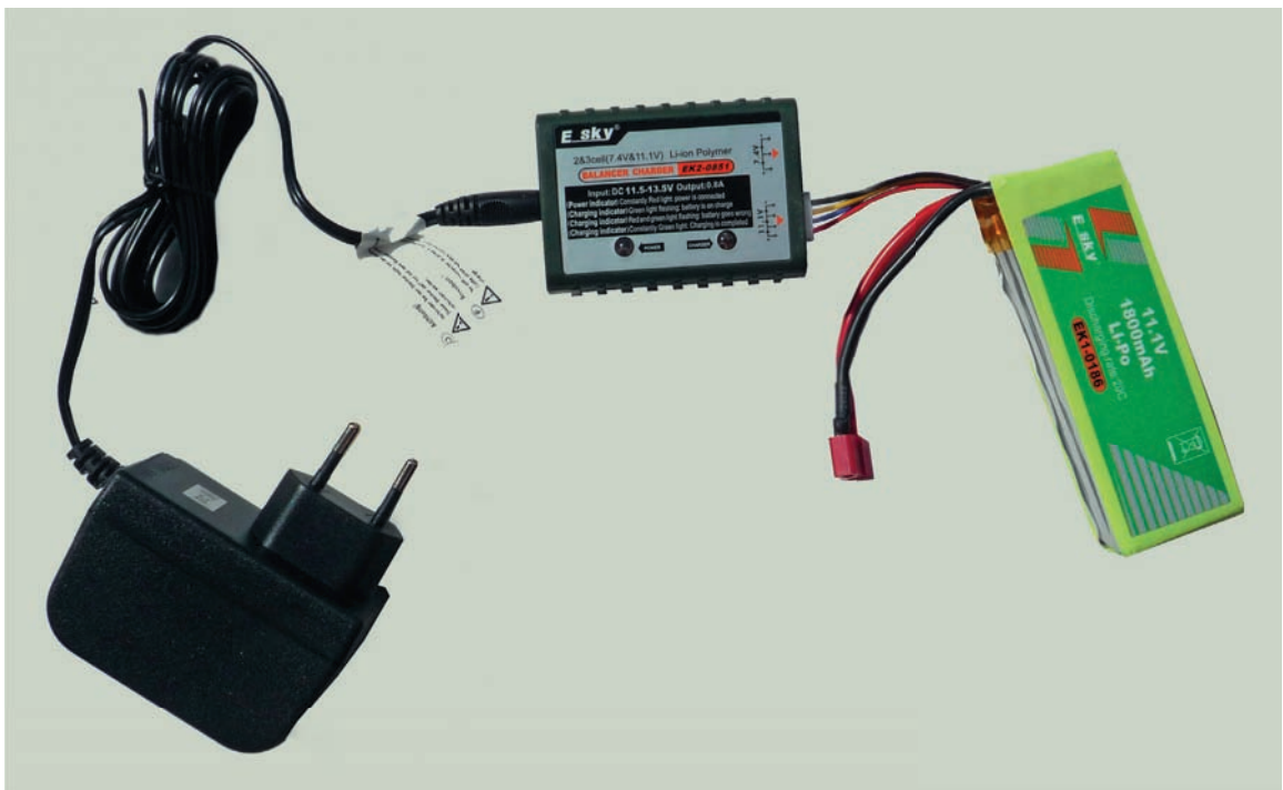
Abb. 12.5 – Das Ladegerät zwischen 230-V-Netzstecker und LiPo erlaubt durch den eingebauten Balancer schonendes Laden.
