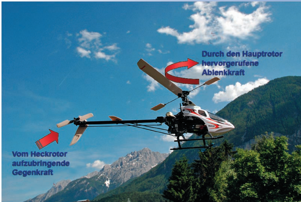
Abb. 2.7 – Der Heckrotor (links im Bild) verhindert das ständige Drehen des Hubschraubers um seine Hochachse.
