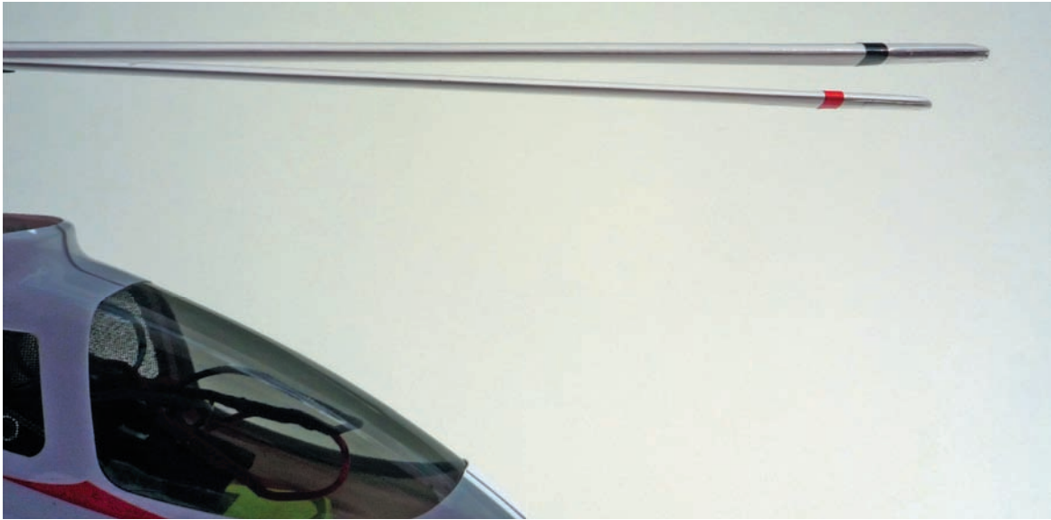
Abb. 7.1 – Bei diesem Heli bewegen sich beide Rotorblätter in verschiedenen Höhen, was die Flugeigenschaften verschlechtert.
