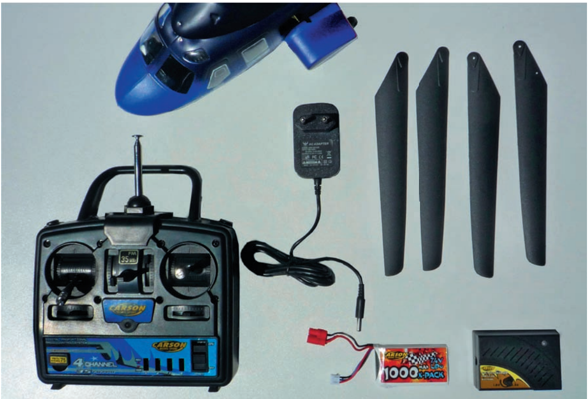
Abb. 3.2 – Inhalt im Detail: Hubschrauber, Fernsteuerung, Akku und Ladegerät mit 230-V-Netzteil.
