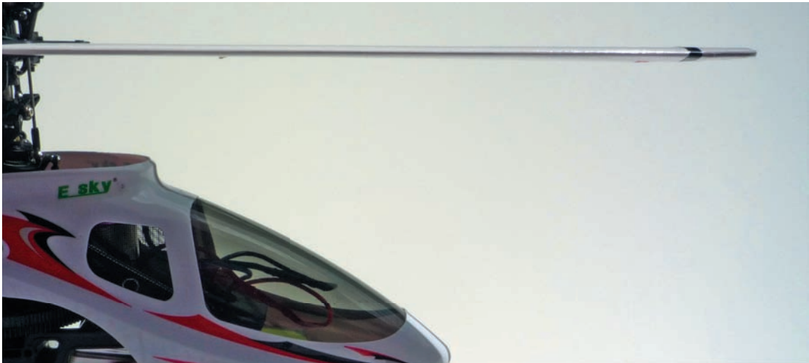
Abb. 7.5 – Nach der Justierung drehen sich beide Rotorblätter in exakt gleicher Höhe.
