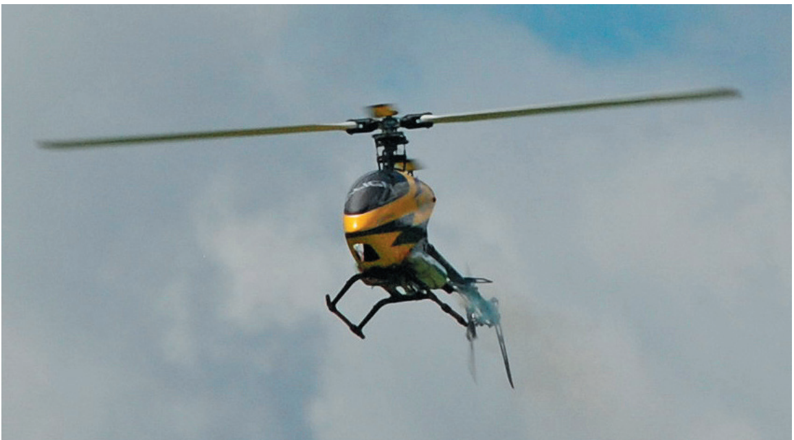
Abb. 2.4 – Für den Vorwärtsflug ist die Nase nach unten gedrückt.
