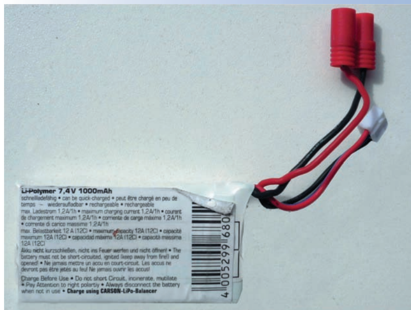
Abb. 12.3 – Dieser Akku erlaubt einen maximalen Entladestrom von 12 A.
