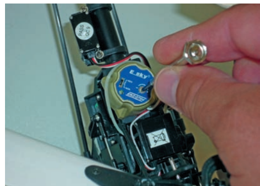
Abb. 7.6 – Die Ansprechempfindlichkeit wird bei diesem Gyro mit einem kleinen Schraubendreher eingestellt.
