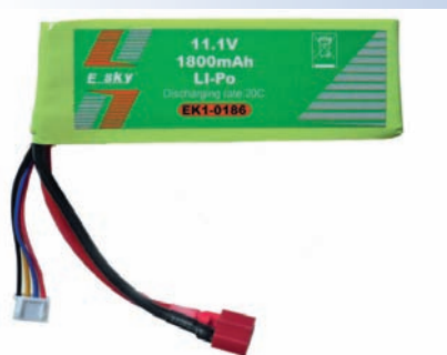
Abb. 12.2 – Dieser 1.800-mAh-Akku lässt einen maximalen Entladestrom von 20 C und damit 36 A zu.
