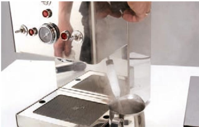
Nehmen Sie ein leeres Kännchen und stellen Sie es unter das Dampfventil. Drehen Sie das Ventil auf, starten den Wasserbezug und lassen Sie so lange überschüssigen Dampf ab, bis heißes Wasser austritt. Dadurch wird die Maschine wie oben beschrieben entlüftet und der Kessel wieder mit Wasser gefüllt.
