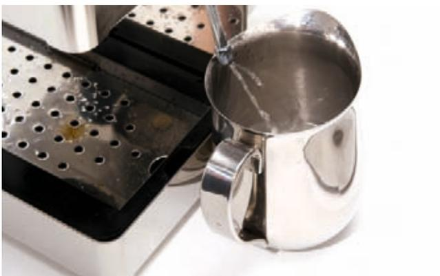
**WICHTIG!** Nach dem Schäumen muss die Maschine entlüftet werden. Halten Sie dazu ein leeres Kännchen unter das Dampfventil, drehen Sie das Dampfventil auf, starten den Wasserbezug und lassen Sie es so lange geöffnet, bis nur noch Wasser austritt. Dadurch wird die Maschine entlüftet, und der Kessel ist wieder mit Wasser gefüllt.
