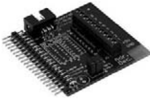
Abb. 32.1: Ein fertiger Port-Expander der C-Control I M-Unit 2.0, der sich in Verbindung des Applicationboards und der Moduladapterplatine für die C-Control PRO einfach aufstecken lässt (siehe Moduladapter CC1 auf PRO).
