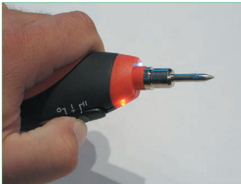
**Abb. 1.13** – Damit sich der BatterielötKolben aufheizt, ist der Taster am Schieber gedrückt zu halten. Zwei Leuchtdioden zeigen den Betriebsstatus an.
