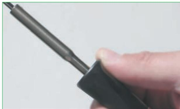
**Abb. 1.4** – Ein kleiner Abrutschschutz schützt die Finger nicht immer ausreichend.
