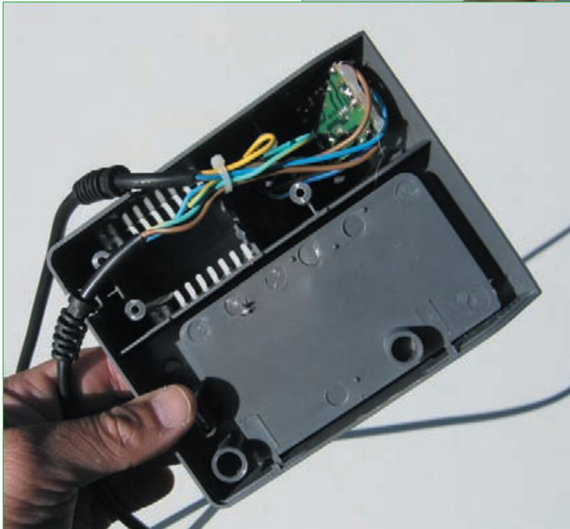
**Abb. 15.9** – Das Innenleben der einfachen Lötstation bringt Gewissheit: Der Trafo für die ungefährliche Sicherheits-Kleinspannung fehlt. Der Lötkolben braucht also 230 V Netzspannung, um zu funktionieren.
