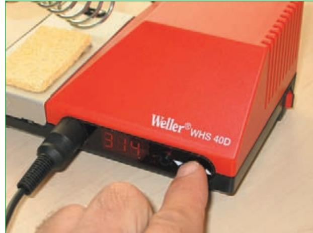
**Abb. 15.4** – Mit Tasten können Sie bei Geräten der soliden und gehobenen Mittelklasse die Löttemperatur gradgenau auswählen, programmieren und auf Tastendruck wieder abrufen.
