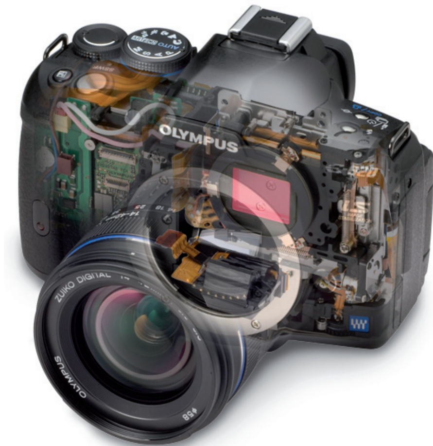
Blick in das Innenleben der E-620: Hinter dem Objektivbajonett sehen Sie die Sensorbaugruppe mit Staubfilter und Tiefpassfilter.
