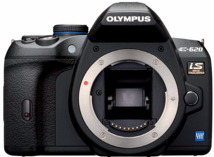
Blick auf den Spiegel der E-620, auf dem sich die Mattscheibe spiegelt.
