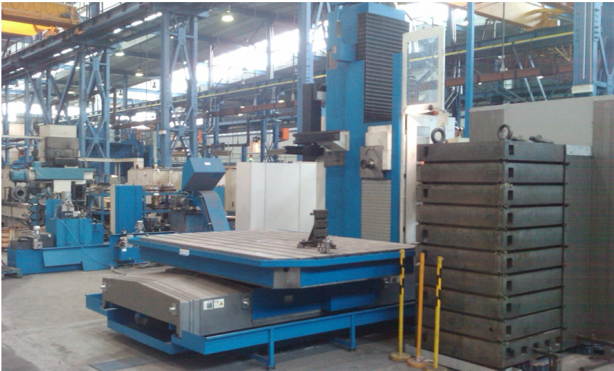
Fig. 2 Installed machine FUE(Q) 125 EFEKTIV in TOS Kuřim
