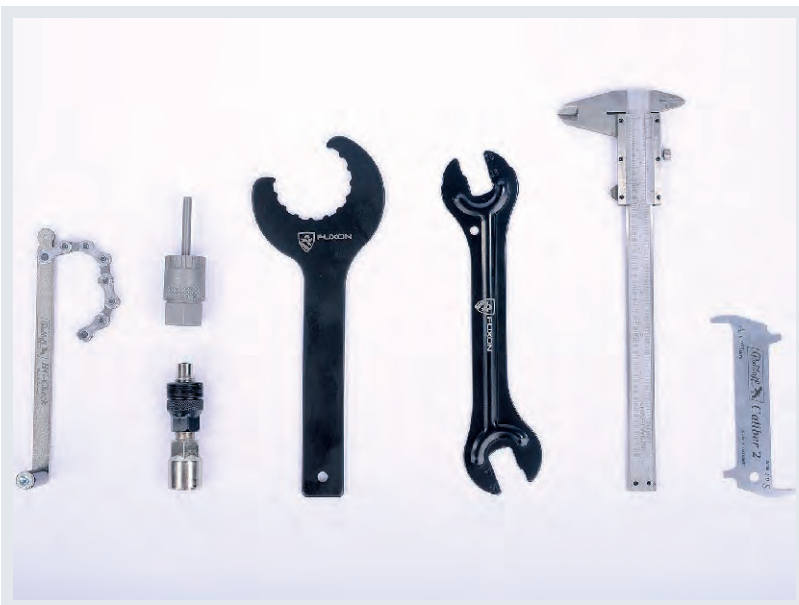
SPEZIALWERKZEUGE von links nach rechts: Verschleißlehre für Zahnkränze, Kurbel- und Kranzabzieher, Tretlagerwerkzeug (Hollowtech), Konusschlüssel, Messlehre, Kettenverschleißlehre
