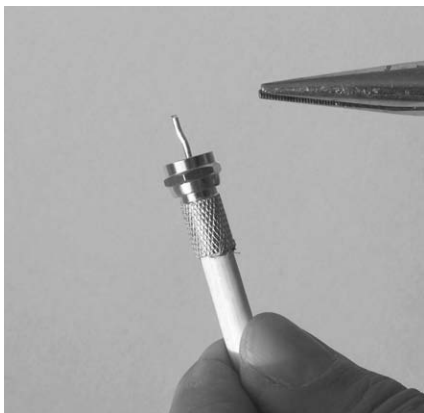
Abb. 6: Viele einfache Reparaturen können eigenhändig durchgeführt werden: Ein schlechter Kontakt an der Steckverbindung eines Koaxialkabels, dessen Innenleiter etwas zu dünn für die Gerätebuchse ist und zu locker in der Buchse sitzt, kann durch leichtes Zubiegen oder Verzinnen des Leiterendes in Handumdrehen behoben werden.
