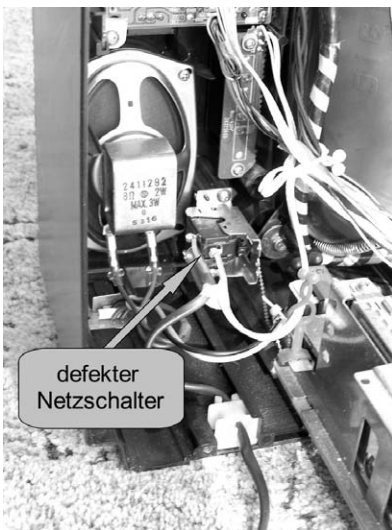
Abb. 10: Ein Fernseher ist nicht unbedingt für die ersten Einsteigerversuche geeignet, aber wenn es sich beispielsweise nur um einen defekten Netzschalter handelt, dürfte sich auch ein unerfahrener Anfänger die Reparatur mit Hilfe dieses Buches zumuten ...
