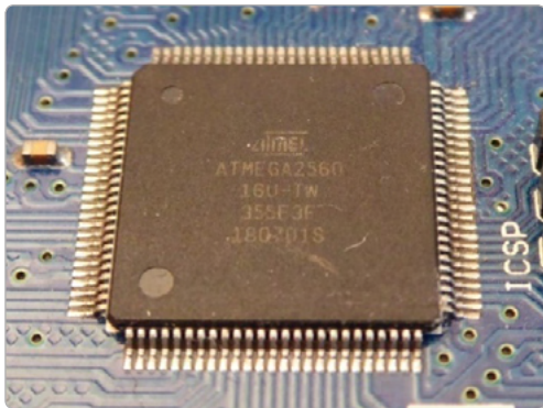
Bild 3.2: Ein Mikrocontroller in SMD-Form.
