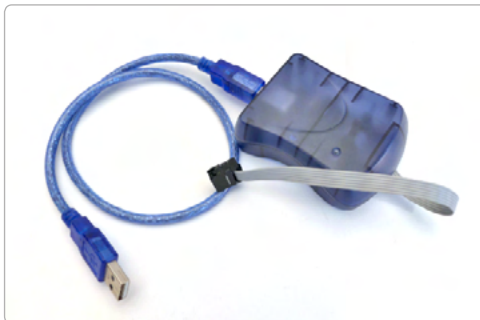
Bild 3.20: Der USB-Tiny-ISP-Programmer programmiert unseren Arduino ganz ohne Bootloader.
