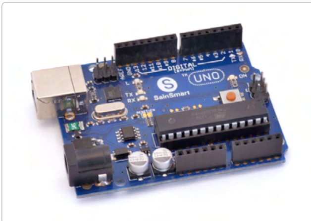
Bild 3.7: Der Arduino Uno – das Einsteigerboard.
