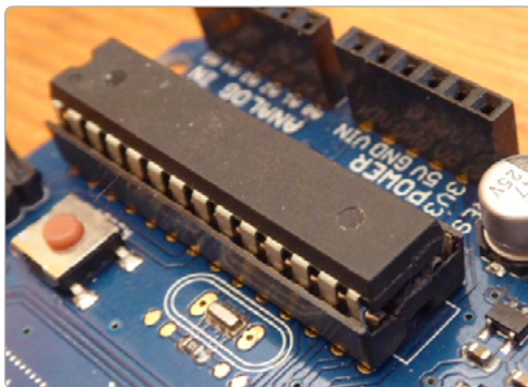
Bild 3.1: Ein steckbarer Mikrocontroller in DIP-Bauform.
