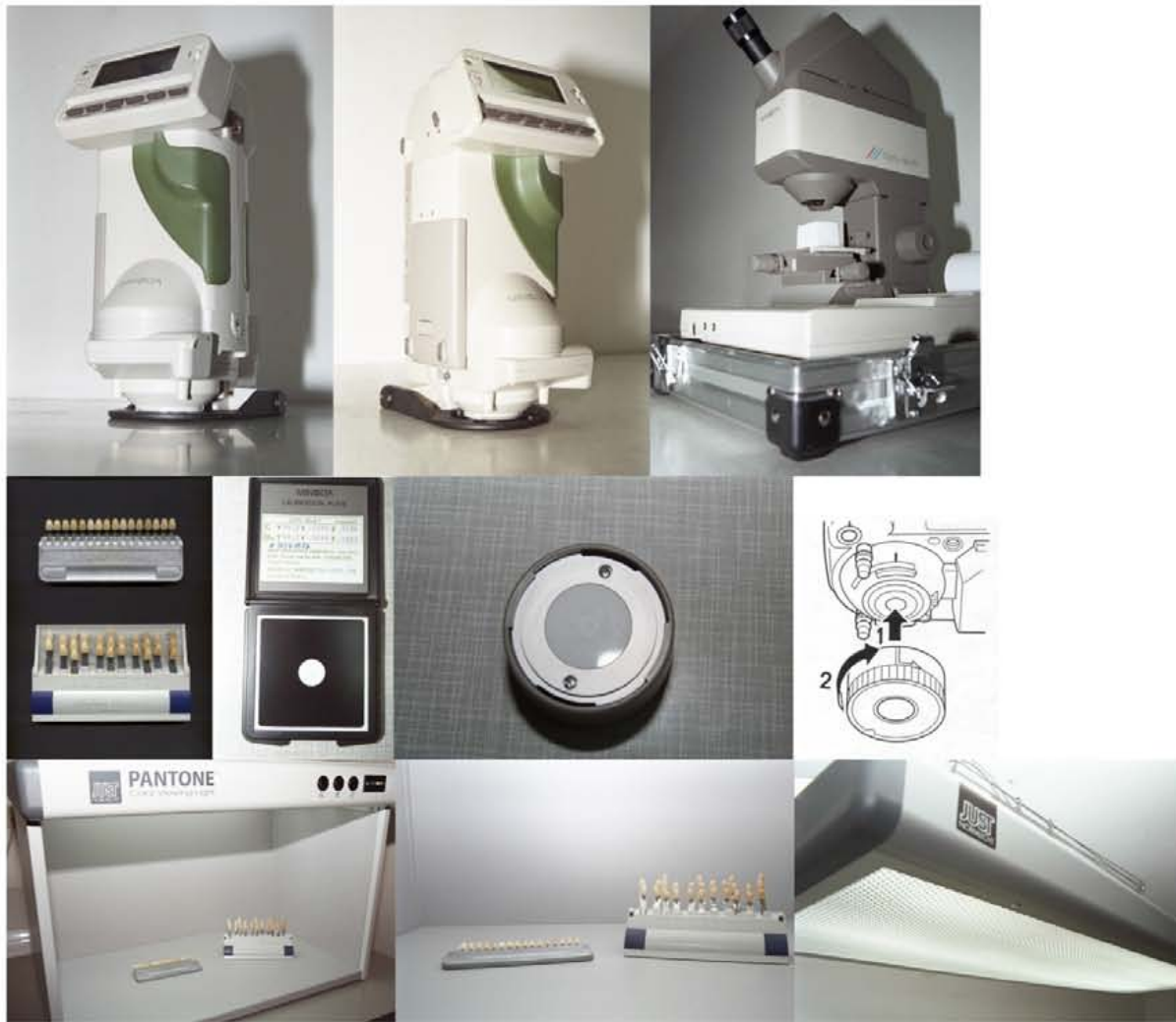
Abb. 3.1-2 Die Spektralphotometer CM-503c (oben links) mit 45/0^\circ -Meßgeometrie (Beleuchtung zirkular unter 45^\circ , Betrachtung unter 0^\circ ) und CM-503i (oben Mitte) mit d/8^\circ -Meßgeometrie ( d/8 , diffuse Beleuchtung, Betrachtung unter 8^\circ zur Senkrechten mit Glanzeinschluß), jeweils von Minolta (Tokio, Japan) besitzen einen Wellenlängenbereich von 400 bis 700 nm, eine Auflösung von 20 nm, eine Xenon-Blitzlampe (vgl. ISO 7724/1; DIN 5033 Teil 7; CIE 15.2 und ASTM E 1164) und wurden ebenso wie das mikroskopische Chromameter CR-241 (oben rechts) (CIE 31, 2^\circ -Normalbeobachter, Xenonblitzlampe, Meßfläche: d 1,8 und 0,3 mm, 45/0^\circ -Geometrie mit Rundumbeleuchtung), ebenfalls von Minolta (Tokio, Japan), in den Voruntersuchungen, Hauptstudien und Nachuntersuchungen eingesetzt. Zum Weißabgleich wurden die Kalibrierstandards CM-A82 (CM-503c) und CM-A2 (CM-503i) (2. Reihe, Mitte rechts) von Minolta (Tokio, Japan) gemäß der Anbringenvorgabe (2. Reihe, rechts) eingesetzt. Für denselben Zweck kam bei dem mikroskopischen Chromameter CR-241 der Weißreflektor (2. Reihe, Mitte links) zum Einsatz. Zentral ist diese Kalibrierplatte weiß gefärbt. Mithilfe dieser Platte wird so eine Weißkalibrierung an dieser Stelle der Platte durchgeführt. Die kaum mit unbewaffnetem Auge zu erkennenden schwarzen Punkte auf dem Weiß der Platte dienen der Scharfstellung des mikroskopischen Chromameters. Sind die Punkte peripher der durch das Linsensystem sichtbaren Randmarkierung des Meßfelds scharf zu erkennen, kann die Kalibrierung durchgeführt werden. Nachdem das Zentrum der weißen Mitte anvisiert ist, werden drei Kalibriermessungen durchgeführt. Zu sehen sind weiterhin die PJC/CVL 3 Pantone® Lichtkabine der Fa. JUST Normlicht GmbH (unten links; Weilheim/Deutschland; D65 Normlicht: 6.500 K-Leuchtstofflampe Philips TL-D 18/965, nördliches Tageslicht, entsprechend den internationalen Normen für visuelle Farbmusterung-CIE D65; D50 Normlicht: 5.000 K-Leuchtstofflampe JUST Color Control Daylight 98 – CIE D50, ANSI PH 2.30, ISO 3664; Normlicht A: 2.700 K-Glühlampe, 2x 60 Watt) sowie die VITAPAN classical- und -3D-MASTER-Farbringe (2. Reihe links) (Fa. VITA, Bad Säckingen/Deutschland), welche hier zur Anwendung gelangten. Die Farbringe befinden sich in der Lichtkabine der Fa. JUST Normlicht GmbH (Weilheim/Deutschland) (unten links und Mitte), in der auch die subjektiven Farbabweiche stattfanden. Die CC/FS 2-SY-2/36 Farbprüfleuchte (unten rechts) diente als Lichtquelle zur Ausleuchtung des Arbeitsbereichs.
