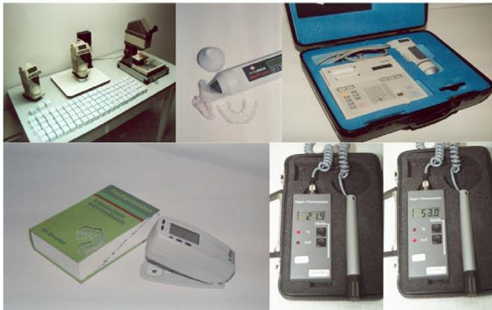
Abb. 3.1-1 In den verschiedenen Voruntersuchungen und Studien fanden extrahierte, von Wurzelhaut, Konkrementen, Zahnstein und Belägen befreite, endodontisch unbehandelte, menschliche, obere mittlere Frontzähne Verwendung (s. oben links). Das elektronische Hygro-Thermometer (Fa. Adolf Thies GmbH & Co. KG, Göttingen, unten rechts) wurde zur Raumüberwachung der Temperatur in Grad Celsius (unten Mitte) und Luftfeuchtigkeit in % (unten rechts) eingesetzt. Die Voruntersuchungen erfolgten mit dem Spektro-pen (Dr. Lange GmbH & Co. KG, Düsseldorf/Deutschland) mit 45/0°-Meßgeometrie (oben Mitte) mit individuell erstelltem Repositionierungsbehelf aus konfektioniertem Abformlöffel im Verbund mit einer den Meßkopf aufnehmenden starren Tiefziehfolie. Das Gipspositiv oben auf dem Bild entspricht dem Meßkopf, dessen Dimensionen zuvor abgeformt und in Gips überführt wurden. Das Gipspositiv wurde zur Erstellung der Tiefziehfolie benutzt. Der Löffel trägt die Abformmasse mit Einbiß des Probanden. Spektraldensitometer 528 (X-Rite, Grandville, MA, USA) mit 45/0°-Meßgeometrie, 3,8 mm Meßflächendurchmesser (unten links) und Chroma-Meter CR-300 von Minolta (Tokio, Japan) mit d/0°-Meßgeometrie (diffuse Beleuchtung, 0°-Betrachtung, Glanzeinschluß, oben rechts).
